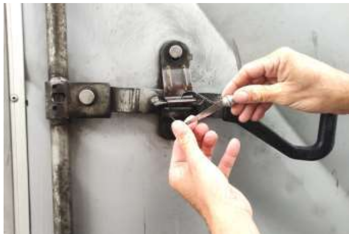
Inserte la cola del sello en el orificio posterior de la cabeza del sello.
