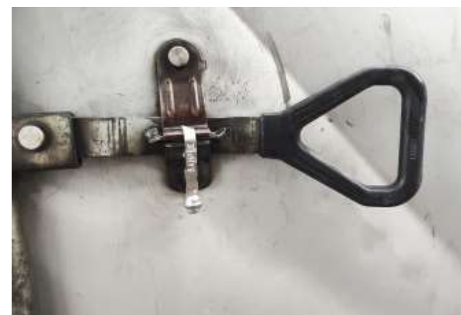
De esta manera se obtiene el autobloqueo del sello. La única manera de abrirlo es romperlo.
